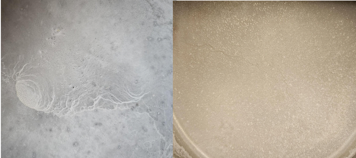
Abb. 17: Links: Trockenrückstand in einem Stahltopf von 2 Litern unbehandeltem Leitungswasser. Rechts: Trockenrückstand im Topf von 24 Stunden AMTech 700-behandeltem Leitungswasser. Die Gleichmäßigkeit des Trockenrückstands bei AMTech-behandeltem Wasser fällt deutlich auf.
