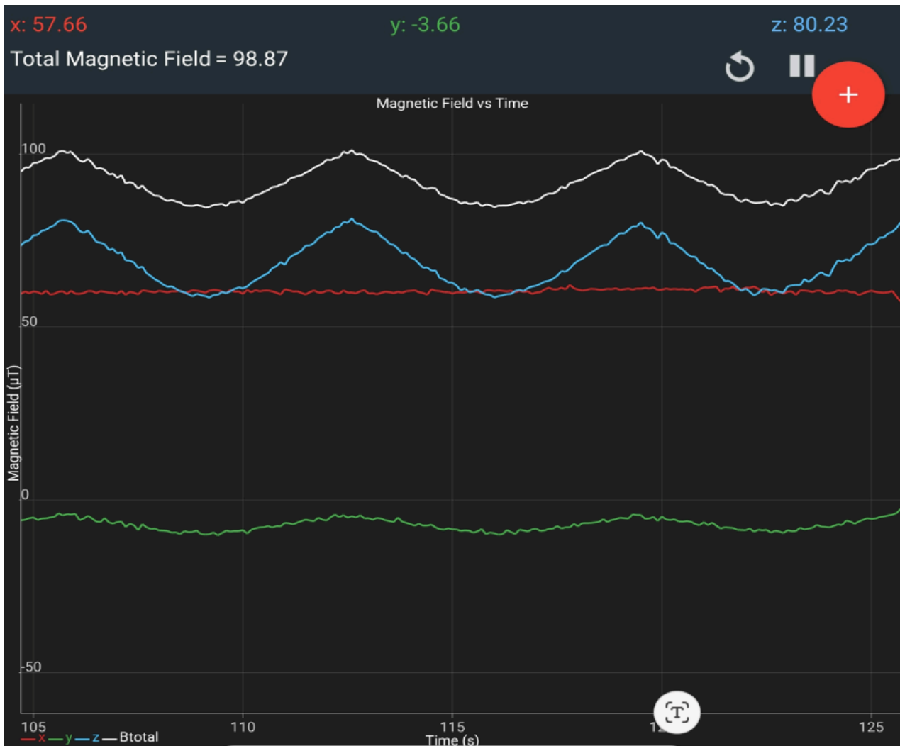
Abbildung 5: Elektromagnetische Emission in x-, y- und z-Koordinaten. Periodisch wechselnde Emission mit einer maximalen Feldstärke von etwa 100 \mu\text{Tesla} , wobei die z-Koordinate etwa 70 \mu\text{T} beträgt. Zum Vergleich: Das Erdmagnetfeld liegt bei etwa 40–50 \mu\text{T} .
